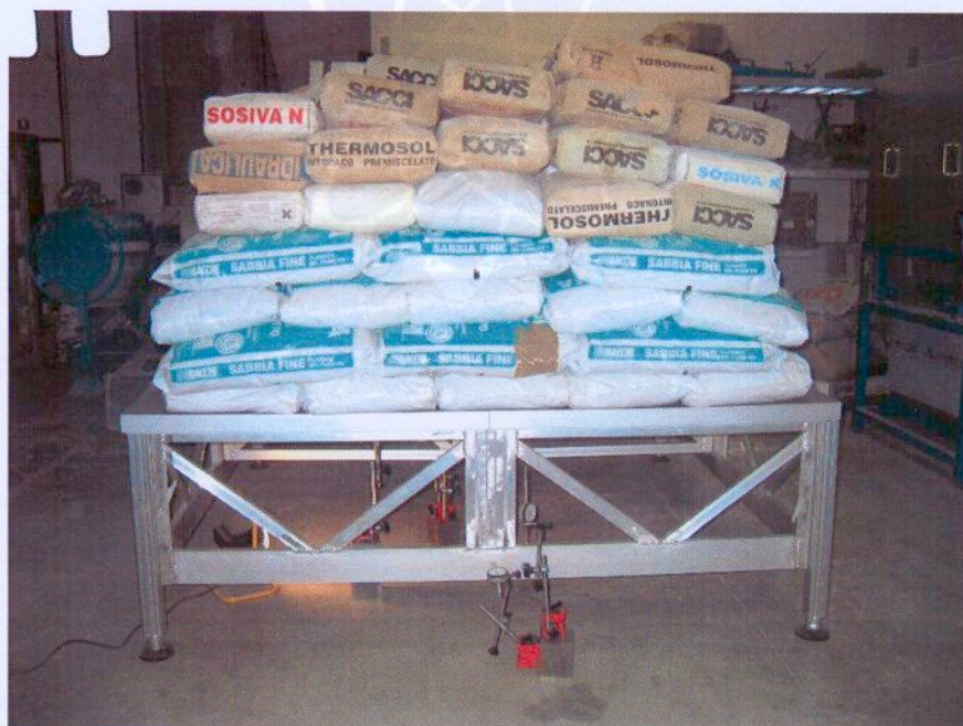
Fotografia del campione con il carico massimo applicato e disposizione degli strumenti di misura.
