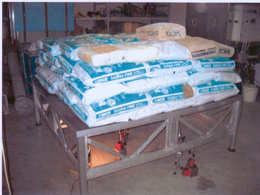
Fotografia del campione durante una fase di carico.
